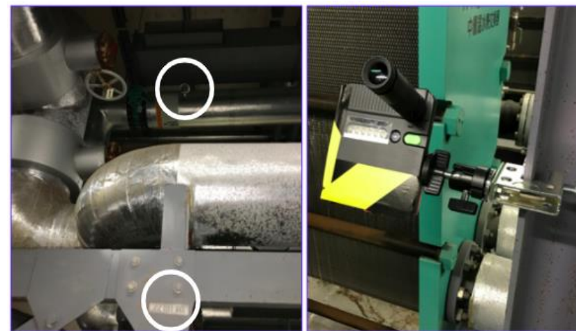
市販のスマホ用 望遠レンズ装着で遠い位置にある計器も読取OK
